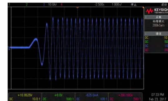
5.5kW异步电动机160%负载快速启动电流波形
